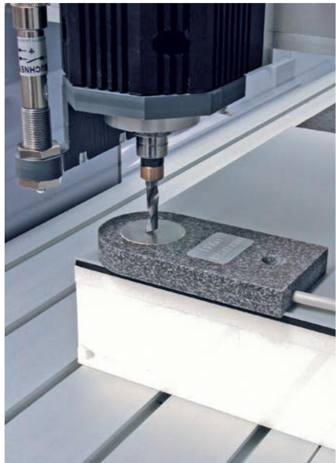
Einmessen der Werkstückoberfläche in Sekundenschnelle mit der mobilen Justiereinrichtung.
