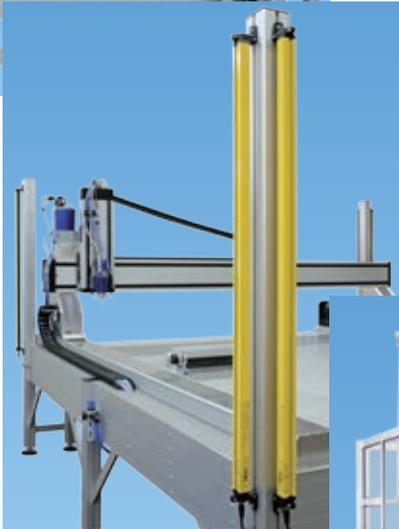
← Vierseitiger Schutz der Maschine durch ein Lichtgitter, ohne zusätzliche Einhausung durch Scheiben. Wird während der Bearbeitung in den Bereich des Lichtgitters eingegriffen, schaltet die Maschine in den Halt-Zustand. Dies ist vor allem empfehlenswert bei größeren Maschinen, die ringsum zur Beschi-ckung zugänglich bleiben sollen.
