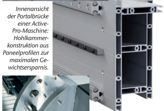
Innensicht der Portalbrücke einer Active-Pro-Maschine: Hohlkammerkonstruktion aus Paneelprofilen zur maximalen Gewichtersparnis.
