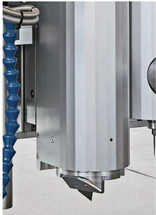
Der Universalkopf eignet sich für viele Anwendungen – hier ist er mit einem V-Cut-Messer für 45-Grad-Schrägschnitte ausgestattet.
