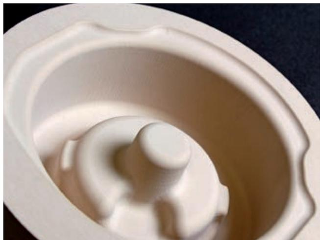
Produktionsmodell aus dem Modellbauwerkstoff Ureol.
