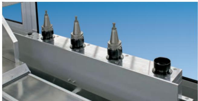
Wechselstation SK 30: Die Station befindet sich in einem separaten Bereich außerhalb des eigentlichen Maschinentischs.
