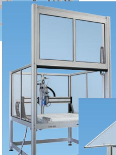
→ Dreiseitige Einhausung einer CAM 450 Classic mit pneumatischem Hubtor. Die Höhe der Seitenteile beträgt 111 cm. Das Tor schließt sich automatisch vor der Bearbeitung.
