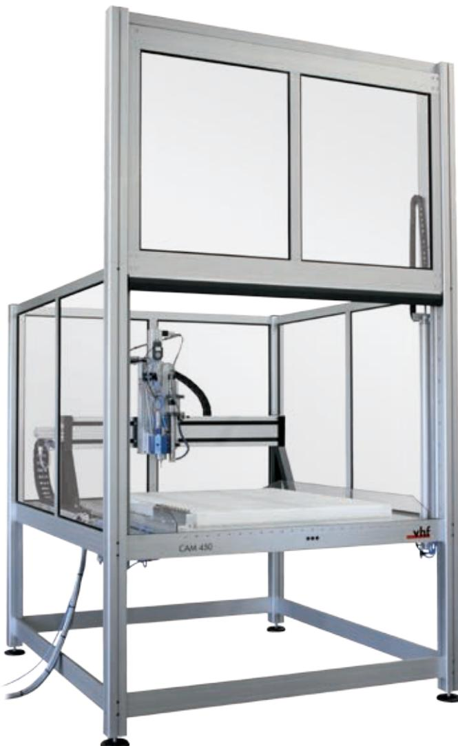
CAM 450 Classic mit serienmäßigem Untergestell sowie vollständiger Einhausung mit automatischem Hubtor.
