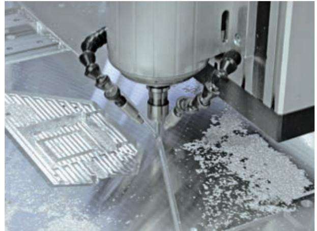
Fräsen von Maschinenteilen bei der vhf camfacture AG.
