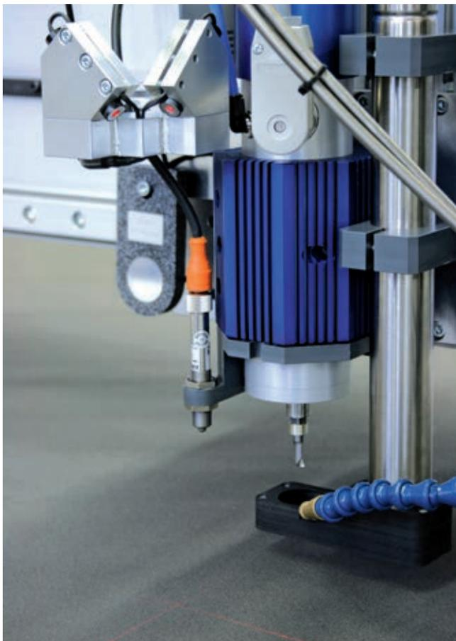
Die Linienlaser (links oben) projizieren Markierungen auf den Tisch, an denen Sie Ihre Werkstücke leicht ausrichten können.
