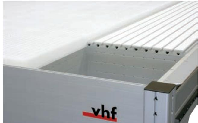
Verschiedene Spannmöglichkeiten auf einer Maschine: Spezial-Vakuumtisch (links), Frontspannbereich für hohe Werkstücke sowie dahinter ein T-Nuten-Tisch.
