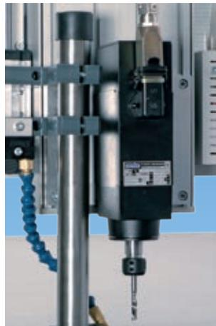
SPC 1000, die kleinste Drehstromspindel.
