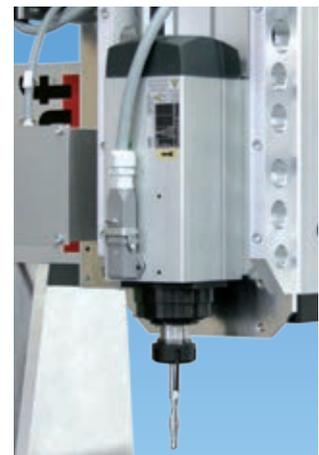
Kraftpaket: SPC 6000 mit 6 kW Dauerabgabeleistung.
