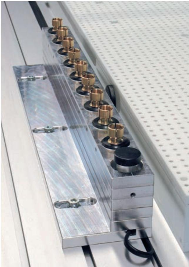
9-fach Wechselstation für Schnellfrequenzspindeln (vorne im Bild: Einmesstaster).
