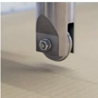
← Schneiden von Passepartouts mit dem kurzen V-Cut-Aufsatz des Universalkopfes.
