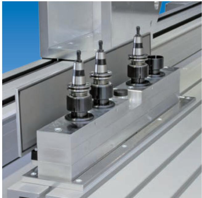
Wechselstation WK 19: Während des Wechselvorgangs fährt die Station automatisch nach oben, während der Bearbeitung ist sie durch die Klappe vor Spänen und Ölnebel geschützt.
