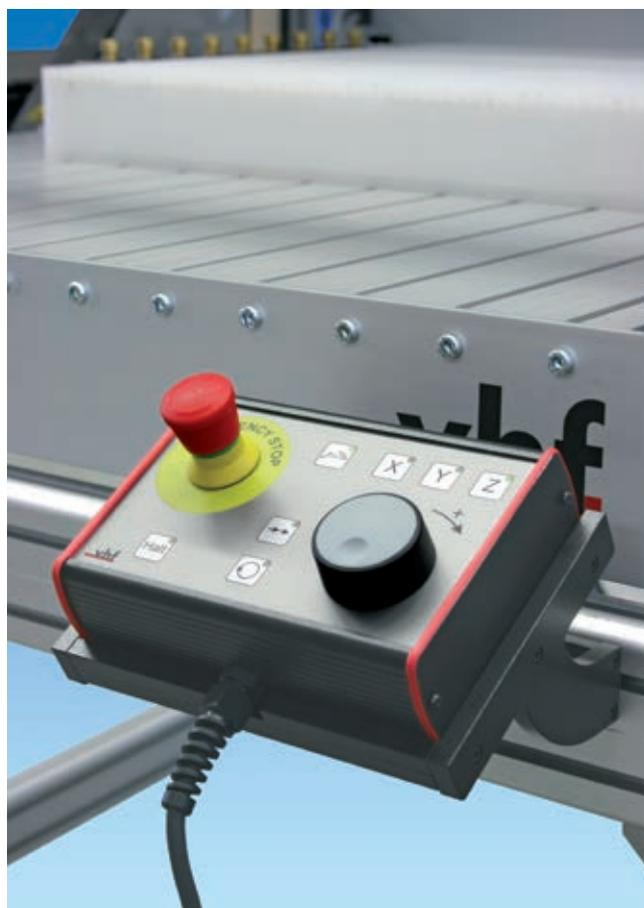
Komfortables Einrichten der Maschine per Control Panel (hier in der Haltevorrichtung).
