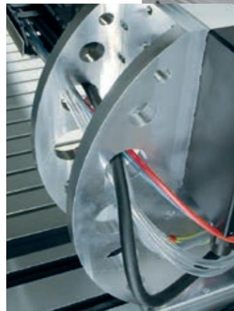
Die Haltewinkel der Portalbrücke einer Premium-Maschine folgen dem gleichen Konzept: die ausgefrästen Löcher sparen Gewicht, kosten aber keine Steifigkeit, so dass eine schwingungsarme Bearbeitung gewährleistet ist.
