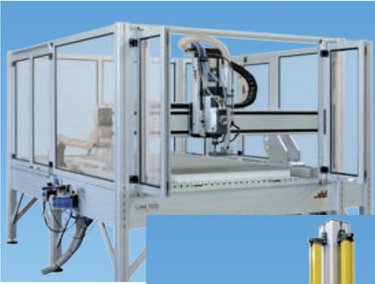
← Dreiseitige Einhausung einer CAM 1020 Premium mit Falttüren an der Vorderseite sowie zwei weiteren Falttüren im hinteren Bereich an beiden Maschinen-seiten. Die hinteren Türen erleichtern das Auflegen und Ausrichten der Werkstücke. Die Fronttüren sind im Bild geöffnet, die beiden hinteren sind geschlossen.
