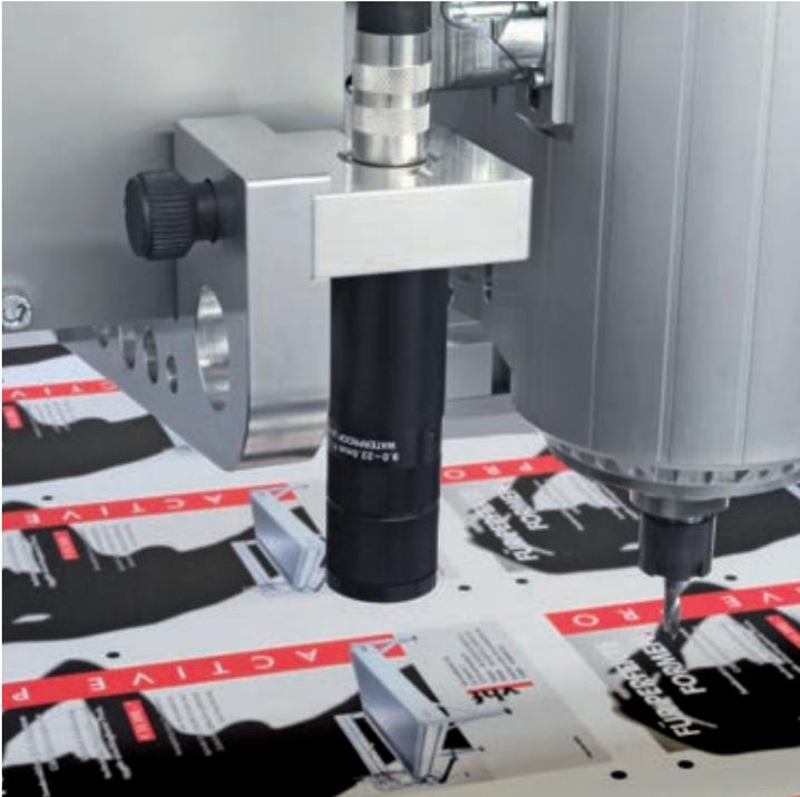
Cenon CCD erkennt die aufgedruckten Justiermarken und berechnet daraus die erforderliche Drehung und Skalierung der Ausgabepfade.
