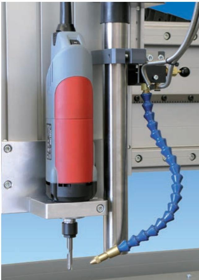
Standard-Spindel – eine preiswerte Alternative für Arbeiten, bei denen es nicht auf hohe Präzision ankommt.
