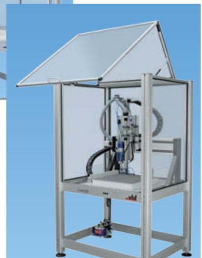
→ Einhausung mit Abdeckhaube einer CAM 220 Classic. Die Haube wird von Hand aufgeklappt und ist zusätzlich mit einem Sicherheitskontakt ausgestattet, der die Maschine beim Öffnen in den Halt-Zustand schaltet.
