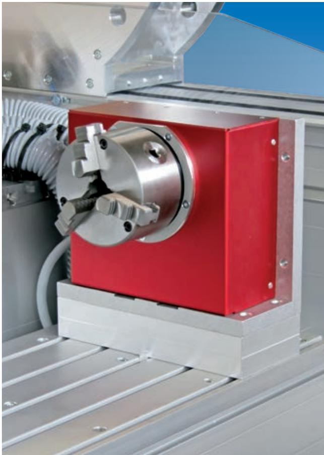
Drehachse vom Typ L mit Dreibackenspannfutter, montiert im Heckspannbereich einer Premium-Maschine.
