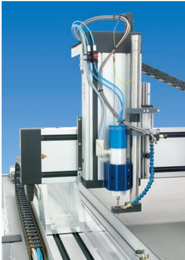
Detailansicht der Brücke mit z-Achse einer CAM 1525 Premium mit einer Schnelfrequenzspindel SF 650P.
