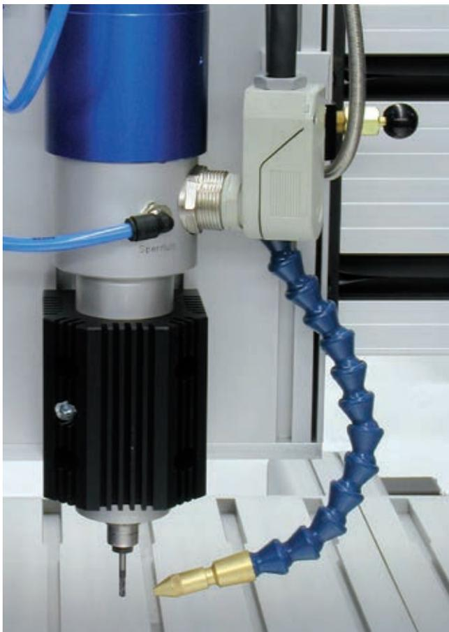
Manuell geschaltete Kühl-/Sprühvorrichtung, montiert rechts von der Schnellfrequenzspindel.
