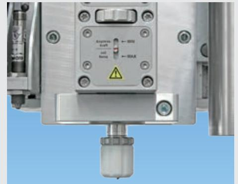
Die Lanze ragt ein kleines Stück weit aus der Distanzhülse heraus; mit dem Stellrad oben wird die Andruckkraft eingestellt.
