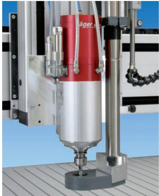
Absaugvorrichtung für eine Drehstromspindel SPC 2300P mit WK-19-Kegelwechsel.
