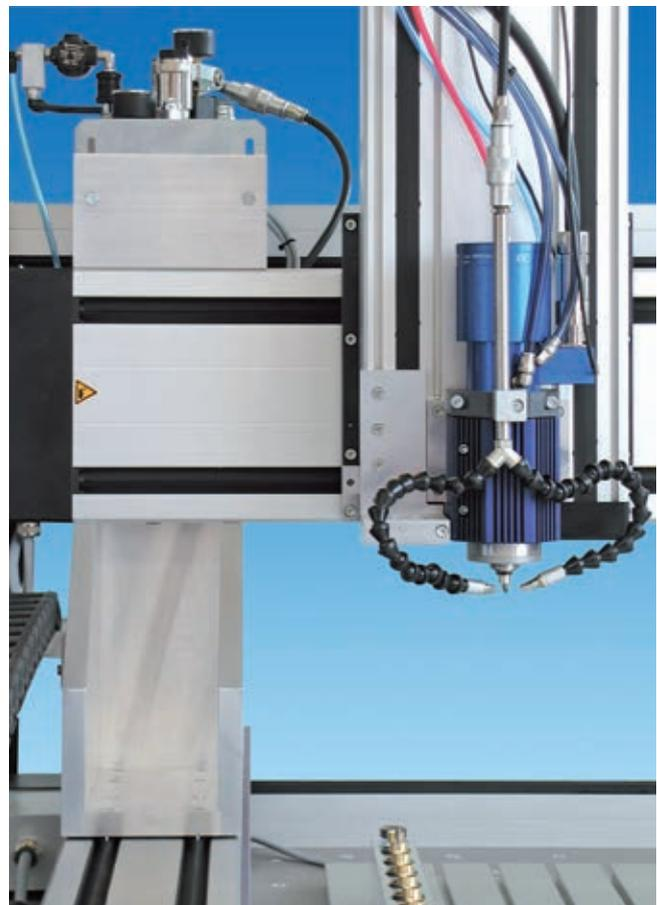
Minimalmengenschmierung mit zwei flexiblen Sprühdüsen, links oben: Steuereinheit mit Flüssigkeitstank und Armaturen.
