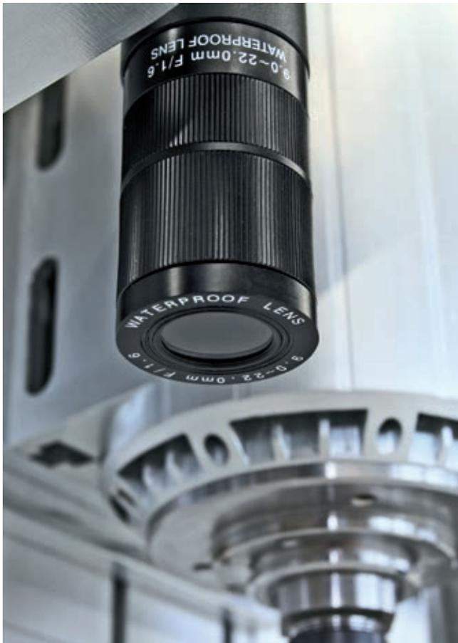
Das CCD-Kamerasystem erfasst Justiermarken auf den Werkstücken oder die Werkstückecken selbst.
