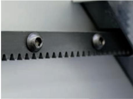
← **Antriebskonzept:** Die Kraftübertragung erfolgt durch einen Zahnstangenantrieb. Dieser kann in fast beliebigen Längen ausgeführt werden, so dass der Maschinengröße kaum Grenzen gesetzt sind.
