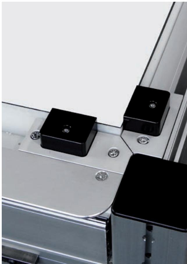
Pneumatisches Anschlagssystem: im Bild die beiden ausgefahrenen Pneumatikzylinder an der Eckposition.
