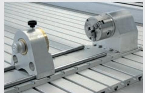
Drehachse vom Typ S mit Dreibackenspannfutter (rechts) und Reitstockeinheit mit Pinole (links).
