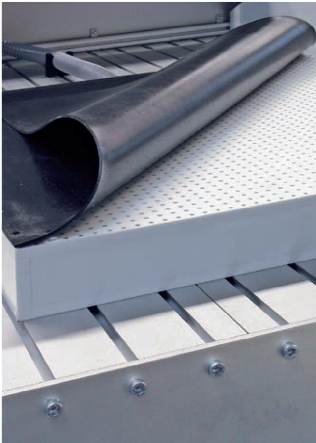
Einzelnes Modul eines Spezial-Vakuumschisches auf einer CAM 250 Classic mit passender Adaptermatte.
