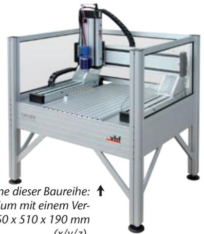
↑ Die kleinste Maschine dieser Baureihe: CAM 0505 Premium mit einem Verfahrbereich von 550 x 510 x 190 mm (x/y/z).
