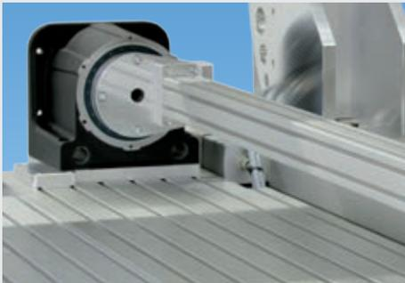
Detailansicht einer Drehachse für Profilmaterial auf Basis von Typ XL mit T-Nuten-Spannbereich auf einer Premium-Maschine.
