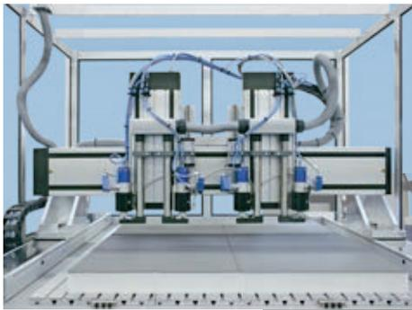
← Mehrspindellösungen für die schnelle industrielle Nutzenfertigung.
