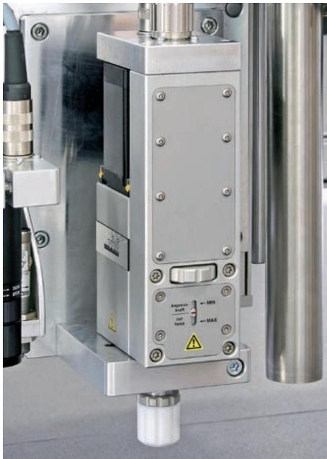
Tangentialschneidkopf mit federnd gelagerter Schneideinheit für Folien und Flockmaterial.
