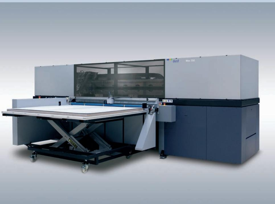
Die weltweit einzige für den Wellpappendruck konzipierte UV- Inkjet Druckmaschine, ist nun mit 80 % mehr Produktivität bei gleicher Qualität erhältlich. Möglich wurde dies durch die Verdoppelung der Düsenanzahl im neuen Quadro Array 30D Druckkopf. Zusätzlich wurden beim voll automatischen Bogenanleger und -ableger die Ladezeiten drastisch reduziert.
